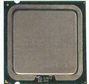
インテルのクアッドコアCPU「Core 2 Extreme QX6850」。内部は写真のようにデュアルコアが2ダイ入っている。
