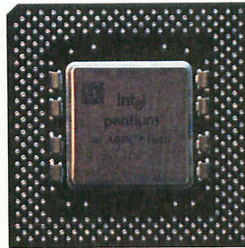
Pentiumは1クロックで2命令を、写真のMMX Pentiumは1命令で多数の演算を実行可能にした。
