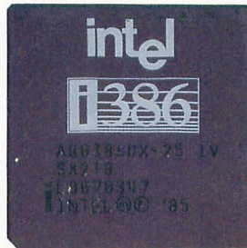
現在で言うx86はこのIntel 80386で成立した。32bit化を果たした上、8086との互換性も取りやすくなっていた。
