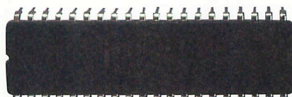
Intel 8086。8080の約5倍のトランジスタを集積して、別次元の機能と性能を実現。IBM PCに採用されてブレイクした。
